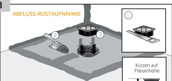
Die Abflussrost Aufnahme muss auf Fliesenhöhe abgesägt werden und wird anschließend mit Fliesenkleber fixiert.
