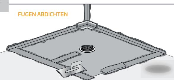
Die Randanschlussfugen sind unbedingt abzudichten (Dichtset optional erhältlich). Bei Bedarf müssen Dichtinnen- und Außenecken verwendet werden (Dichtinnen- und Außenecken optional erhältlich).
