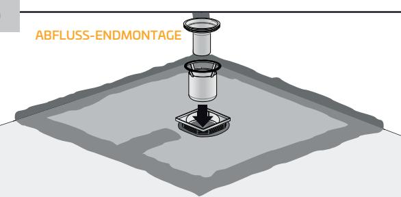
Geruchverschlusseinsätze nacheinander einsetzen. Danach kann die Verfliesung unter Verwendung eines flexiblen Fliesenklebers begonnen werden.
